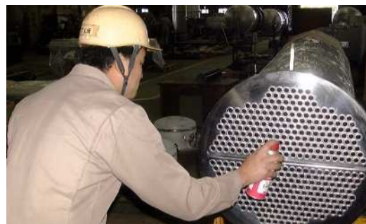
▲浸透探傷試験
