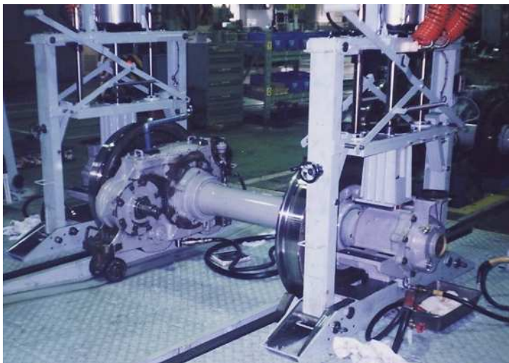
▲高速オイルフラッシング装置
